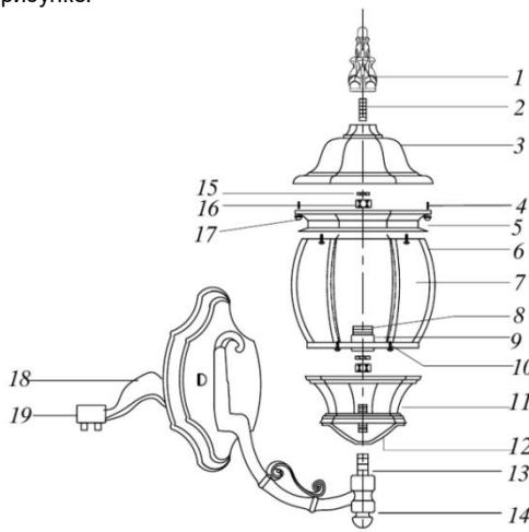
1 – балюсина; 2 – полое винтовое крепление; 3 – крышка; 4 – винты; 5 – верхнее основание; 6 – каркас; 7 – стеклянный рассеиватель; 8 – патрон; 9 – ламподержатель; 10 – винты; 11 – нижнее основание; 12 – 4 декоративных опоры; 13 – полое резьбовое крепление; 14 – опора светильника; 15 – гровер; 16 – гайка; 17 – винты; 18 – провод защитного заземления; 19 – клеммник для подключения питания.
