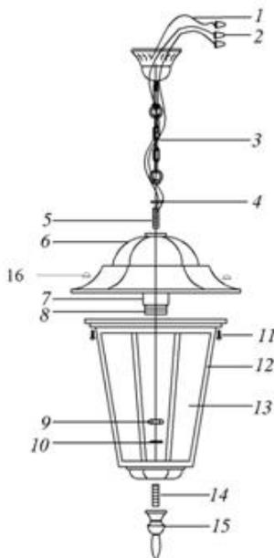
1 – провод заземления; 2 – провода питания; 3, 4 – цепь подвеса; 5 – малое резьбовое крепление; 6 – алюминиевая крышка; 7 – ламподержатель; 8 – керамический патрон; 9 – гайка; 10 – гровер; 11 – крепежные винты; 12 – металлический каркас; 13 – стеклянный рассеиватель; 14 – большое резьбовое крепление; 15 – декоративная балясина.
