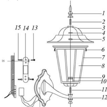
1 – балюсина; 2 – большое резьбовое крепление; 3 – крышка; 4 – гровер; 5 – гайка; 6 – винты; 7 – каркас; 8 – стеклянный рассеиватель; 9 – патрон; 10 – ламподержатель; 11 – малое резьбовое крепление; 12 – основание; 13 – саморезы; 14 – крепежная скоба; 15 – крепежные отверстия; 16 – шайба.
