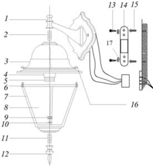
1 – балюсина; 2 – малое резьбовое крепление; 3 – крышка; 4 – ламподержатель; 5 – патрон; 6 – винты; 7 – каркас; 8 – стеклянный рассеиватель; 9 – гайка; 10 – гровер; 11 – большое резьбовое крепление; 12 – основание; 13 – саморезы; 14 – крепежная скоба; 15 – фиксаторы саморезов; 16 – шайба.
