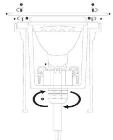
5.12 При установке светильника определите глубину погружения светильника так, чтобы внешнее кольцо светильника не было утоплено в грунт и не выступало выше его уровня:
