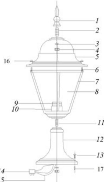
1 – балюсина; 2 – резьбовое крепление; 3 – гровер; 4 – гайка; 5 – верхняя крышка; 6 – винты; 7 – каркас; 8 – стеклянный рассеиватель; 9 – патрон; 10 – ламподержатель; 11 – резьбовое крепление; 12 – постамент; 13 – винт; 14 – клеммник; 15 – провод защитного заземления; 16 – декоративная гайка.
