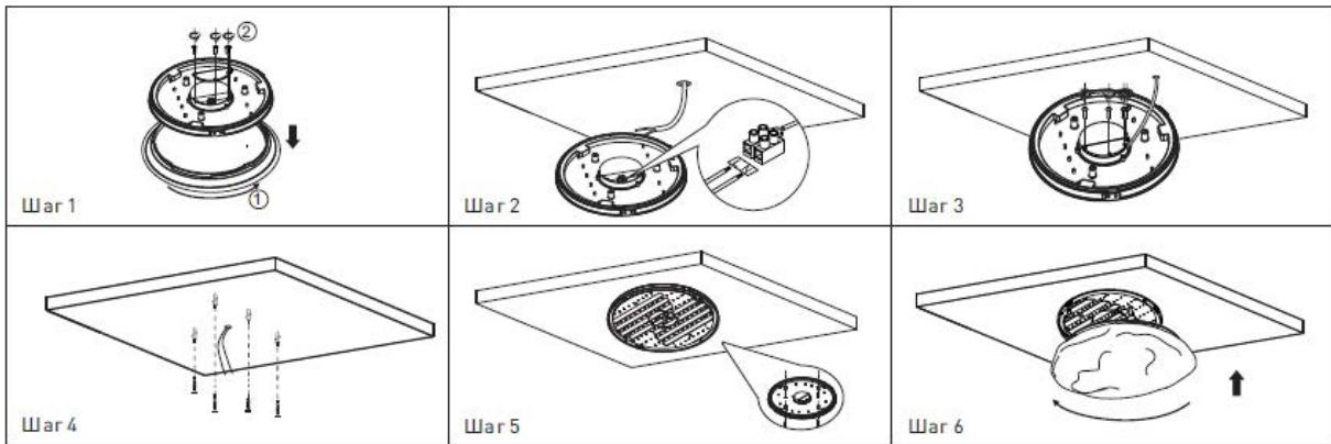
5.4 Снимите рассеиватель светильника и наметьте отверстия для сверленияя поверхности в соответствии с крепежными отверстиями светильника.
