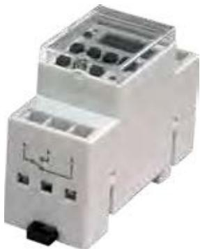
Реле времени электронное без задержки включения предназначено для коммутации электрических цепей переменного тока при номинальном напряжении 220В/50Гц и постоянного тока в диапазоне напряжений 24-100В.
