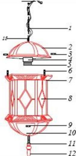
1 – цепь для подвеса; 2 – крышка; 3 – гайка; 4 – ламподержатель; 5 – патрон для лампы; 6 – винты; 7 – каркас; 8 – рассеиватель; 9 – гайка;
