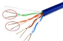
Рисунок 4 Витая пара UTP: для использования рекомендуются провода оранжевого и зеленого цветов
