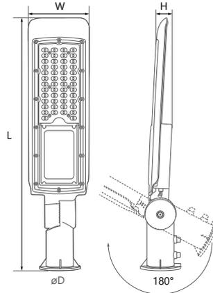
Поворотная консоль позволяет устанавливать светильник на различные монтажные поверхности и регулировать угол наклона.
