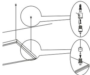
Тросы LD510 предназначены для подвесного крепления светодиодных светильников TM FERON AL2113.
