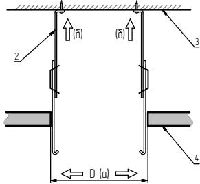
2. Смонтировать светильник на установленные подвесы АП-Г (b). Подключить светильник к электрической сети (z) в соответствии с требованиями технического паспорта на светильник.
