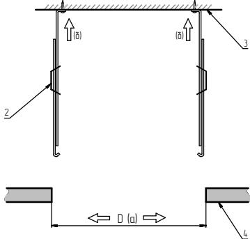
2. Смонтировать переходник на установленные подвесы АП-Г (b). Подключить светильник к электрической сети (e) в соответствии с требованиями технического паспорта на светильник.
