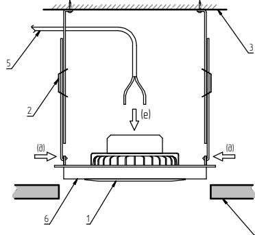
3. Определять высоту подвеса таким образом, чтобы лицевая поверхность переходника была на уровне потолка "Грильято" (x).
