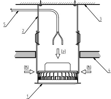
3. Определять высоту подвеса таким образом, чтобы декоративная рамка светильника была на уровне потолка "Грильято" (x).
