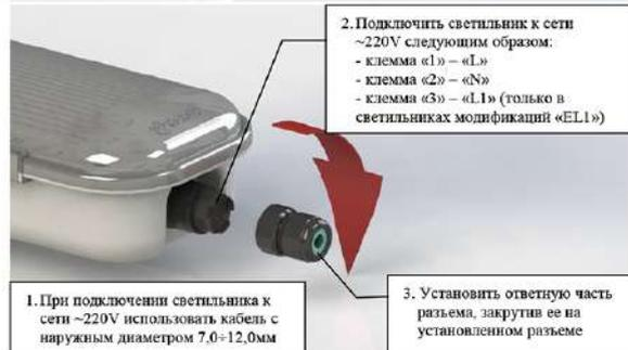
2. Подключить светильник к сети ~220V следующим образом:
