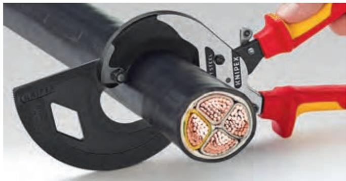
Первые ручные ножницы с храповым механизмом для перерезания медного и алюминиевого кабеля диаметром до 60 мм одной или двумя руками.
