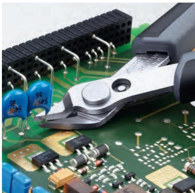
Клещи с функцией снятия электростатического напряжения (ESD): в этом инструменте электростатическая энергия медленно и под контролем отводится через ручки, это защищает конструктивные элементы, подверженные риску воздействия электростатических разрядов согласно действующим нормам, например, IEC TR 61 340-5, DIN EN 61 340-5, SP Method 2472.
