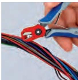
Насадка-уловитель для серии бокорезов KN-79 02 / 22 125 легко надевается на рабочую часть бокорезов, предотвращая падение обрезков — например, при работе с кабельными стяжками. Решение особенно востребовано в отраслях с повышенными требованиями к безопасности, чистоте и аккуратности сборки: аэрокосмической, электросборочной и т. п.
