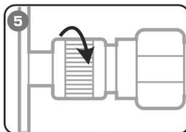
5 Плотно затяните гайку БРС, приложив достаточное усилие (от руки) для обеспечения хорошего соединения (без применения слесарного инструмента)
