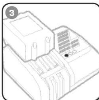
**Вставьте аккумулятор в зарядное устройство до щелчка. Прозвучит звуковой сигнал и загорится красный индикатор. По окончании зарядки аккумулятора, индикатор изменит цвет с красного на зеленый и прозвучит звуковой сигнал.**
