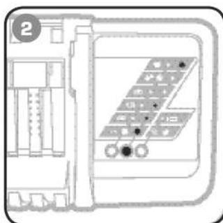
**Убедитесь, что температура окружающего воздуха в помещении 10–40°C. Подключите зарядное устройство в розетку 230 В/50 Гц. При этом замигает зеленый индикатор. Зарядное устройство готово к использованию.**
