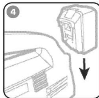
**Время полной зарядки аккумулятора составляет 1,5 часа. Изымите аккумулятор из зарядного устройства и вставьте его обратно в корпус инструмента до щелчка.**
