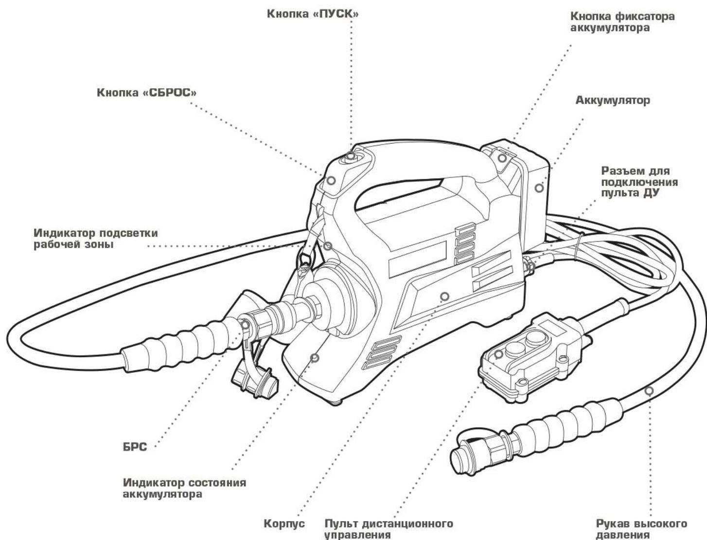
Помпа гидравлическая аккумуляторная ПМА-7005 (КВТ) состоит из корпуса, внутри которого расположен гидроцилиндр, плунжерный насос, приводимый в действие электродвигателем, а также рукава высокого давления РВД. Электродвигатель работает от аккумулятора, который расположен и зафиксирован в задней части корпуса.
