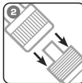
2 Открутите гильзу быстроразъемного соединения и отсоедините рукав помпы от исполняющего инструмента.
