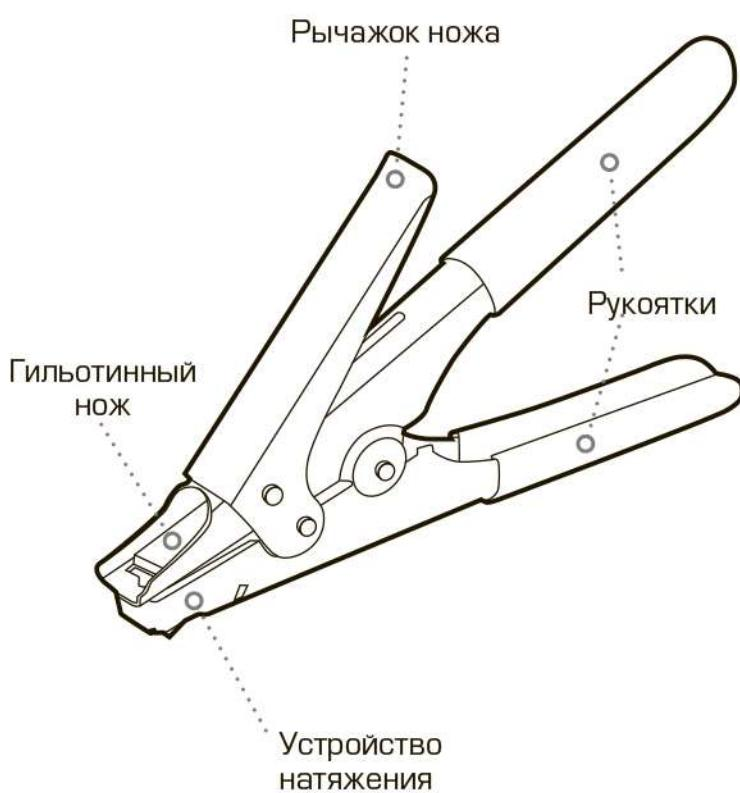
Инструмент для монтажа нейлоновых стяжек состоит из прорезиненных, нескользящих рукояток, устройства натяжения с подпружиненной зубчатой собачкой и встроенного гильотинного ножа для отрезания конца стяжки.
