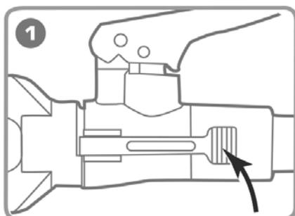
**Полностью сбросьте давление в гидроцилиндре, нажав на педаль клапана сброса давления.**
