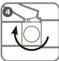
Поверните винт сброса давления в положение «Закрыть».
