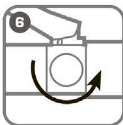
Поверните винт сброса давления в положение «Открыть».
