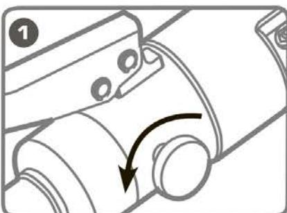
Поверните винт сброса давления в положение «Открыть».
