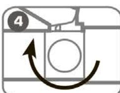
Поверните винт сброса давления в положение «Закрыть».
