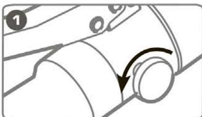
**Поверните винт сброса давления в положение «Открыто».**
