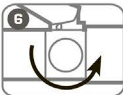
Поверните винт сброса давления в положение «Открыть».
