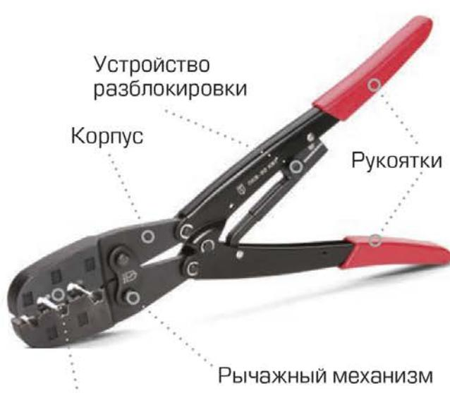
Пресс-клещи ПКВ-50, ПКВ-70 состоят из многопозиционных губок, рукояток, рычажного механизма, храпового механизма и устройства разблокировки
