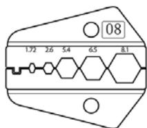
Опрессовка коаксиальных разъемов для телевизионных кабелей RG 6, RG 58, RG 59, RG 62
