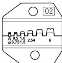
Опрессовка одинарных изолированных и неизолированных втулочных наконечников
