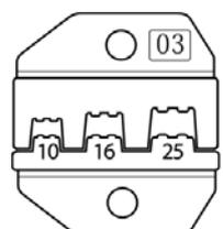
Опрессовка одинарных изолированных и неизолированных втулочных наконечников
