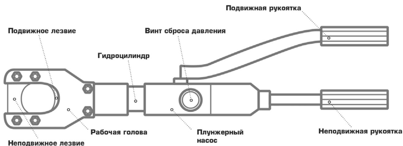
Ножницы гидравлические НГР-53 состоят из гидроцилиндра с рабочей головкой, в которой установлены откидное неподвижное лезвие, подвижное лезвие и винт сброса давления, подвижной и неподвижной рукояток.
