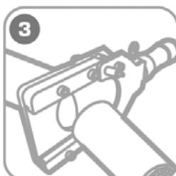
Создайте давление помпой, разрежьте кабель. Сбросьте давление на помпе
