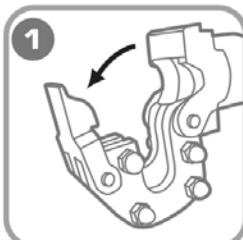
**Отведите замок-фиксатор, откиньте неподвижное лезвие ножниц.**
