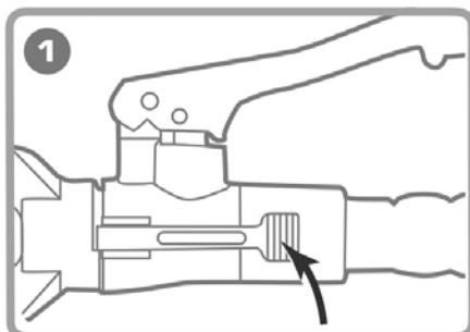
**Полностью сбросьте давление в гидроцилиндре, нажав на педаль клапана сброса давления.**
