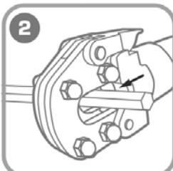
**Установите разрезаемый элемент в рабочей зоне и закройте рабочую голову.**
