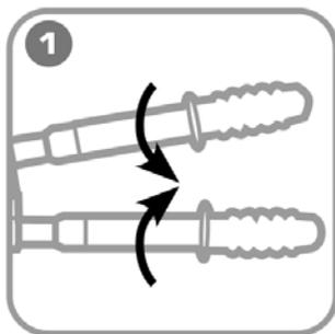
**Расфиксируйте рукоятки, повернув их вокруг оси (для TP-8T, TP-12T).**
