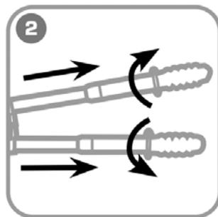
**Установите необходимую длину и зафиксируйте рукоятки, повернув их в противоположную сторону (для TP-8T, TP-12T).**
