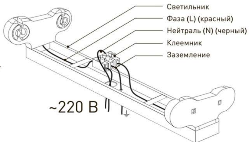
Рис.1. Схема подключения светильника к сети 220В
