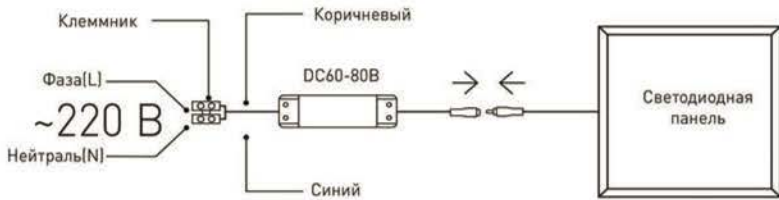
Рис.1. Схема подключения светодиодной панели к сети 220В.
