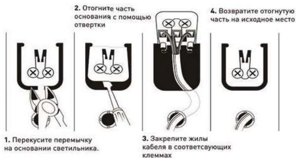
Рис.2. Схема подключения светильника SPO-6-36 к сети 220В.
