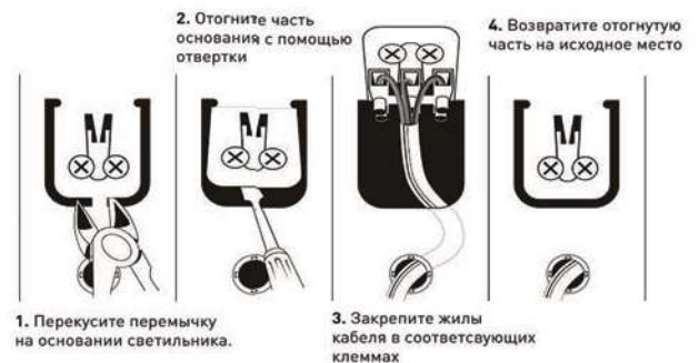
Рис.2. Схема подключения светильника SPO-6-36 к сети 220В.
