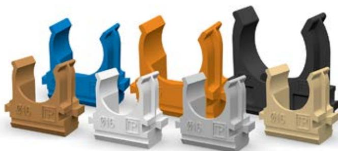
Предназначены для крепления гладких пластиковых труб или гофрированных труб одного диаметра к поверхности стен, потолков, полов или перегородок. Для монтажа предусмотрено технологическое отверстие под дюбель или саморез. Состыковываются друг с другом с помощью специальных фиксаторов типа «ласточкин хвост».
