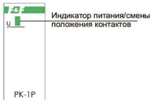
Реле электромагнитное РК-1Р выполнено в одномодульном корпусе для крепления на DIN-рейку 35мм. На передней панели находится индикатор питания/смены положения контактов исполнительно реле.
