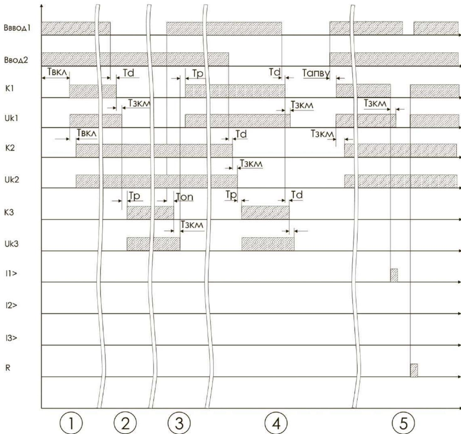
**1** - Включение AVR-01-S(включение обоих вводов). Через время  $T_{вкл}$  происходит подключение нагрузки к вводу1, затем к вводу2.
