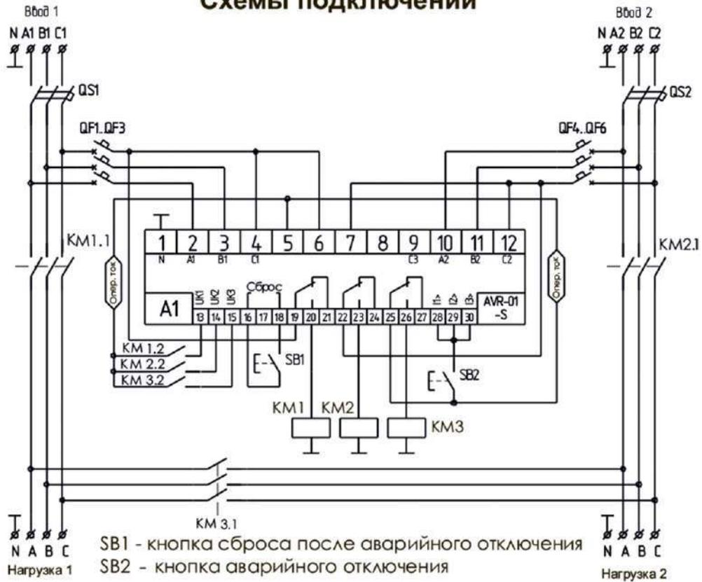
Схема подключения AVR-01-S с контакторами.
