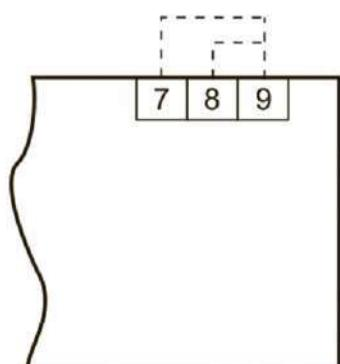
Рисунок 3 - Отключение функции реле напряжения и включение второго варианта расчета мощности
