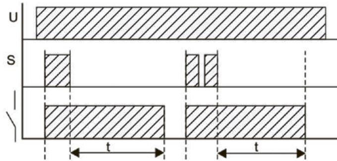
В результате замыкания управляющего контакта 6, контакты реле 11,12 замыкаются. Размыкание управляющего контакта 6 вызывает отсчет установленного времени, по истечении которого работа реле прекращается.
