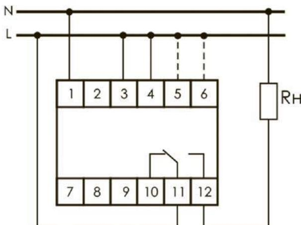
После включения питания и отсчета установленной выдержки времени исполнительное реле включается, замыкаются контакты 11-12. В таком положении реле находится до отключения питания.
