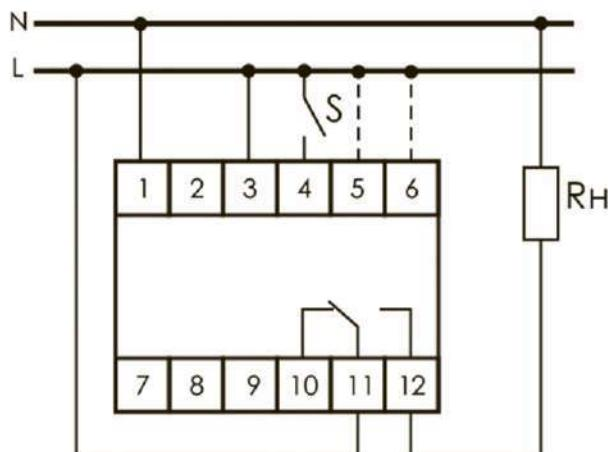
При замыкании контакта S начинается отсчет установленной выдержки времени по истечении которой включается исполнительное реле (замыкаются контакты 11-12). В таком положении реле находится до отключения питания или размыкания контакта S. Если разомкнуть контакт S до истечения выдержки времени, отсчет прекращается. При замыкании контакта S отсчет начинается снова.
