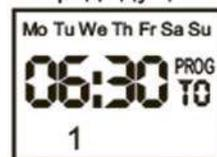
Нажимаем «OK». Переходим к установке функции «Action». Эта функция служит для включения/отключения заданного перерыва в ночное время суток. Кнопками «+» или «-» устанавливаем «on» или «off» (вкл/выкл) для данной функции.
