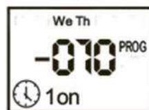
Если требуется производим корректировку, как показано в пункте 5 для этих дней. После чего нажимаем «OK» и переходим к установке времени отключения в ночное время.
