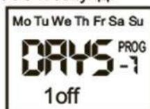
Например, для первого канала требуется отключить ночной перерыв в среду и четверг. Кнопками «+» или «-» выбираем цифру «-3» (справа под «PROG»), нажимаем «OK». В днях недели погаснет «WE» (среда).
