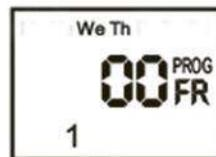
Устанавливаем требуемый нам ночной перерыв также как показано в пункте 6. Аналогично выполняются установки и для второго канала. По окончании этих процедур нажимаем «OK» - реле переходит в режим выполнения заданной программы.
