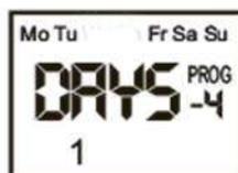
Нажимаем два раза подряд кнопку «MENU» - реле перейдет к корректировке времени включения/выключения для второго канала (выполняется аналогично как для первого). Если требуется, наоборот, задать ночной перерыв в среду и четверг по отдельному графику то кнопками «+» или «-» и «OK» убираем все дни в календаре кроме среды и четверга.
