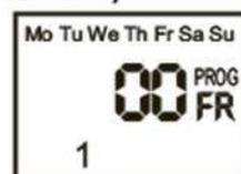
6.1. Кнопками «+» или «-» устанавливаем время выключения, сперва минут, например: 30. Нажимаем «ОК», затем устанавливаем значение часов (01).
