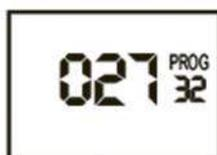
Нажимаем ОК. Реле переходит в режим корректировки времени включения/выключения.
