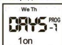
Нажимаем «MENU» - реле переходит в режим корректировки времени включения/выключения относительно времени захода/восхода солнца.
