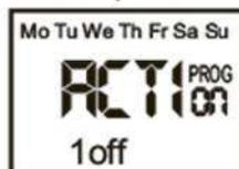
Нажимаем «OK». Переходим к корректировке времени вкл./выкл. относительно захода/восхода солнца и установке времени отключения в ночное время суток для второго канала (аналогично как для первого канала описанного в п.п. 5 и 6). После установки функции «Action» нажимаем «OK». Реле перейдет к выполнению введенной программы, а на экране будет отображаться текущее время.
