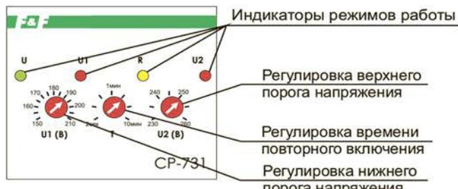
Реле контроля напряжения СР-731 выполнено в трехмодульном корпусе для крепления на DIN-рейку 35мм. На панели управления находятся индикаторы режимов работы, регуляторы нижнего и верхнего порога напряжения, регулятор задержки отключения.
