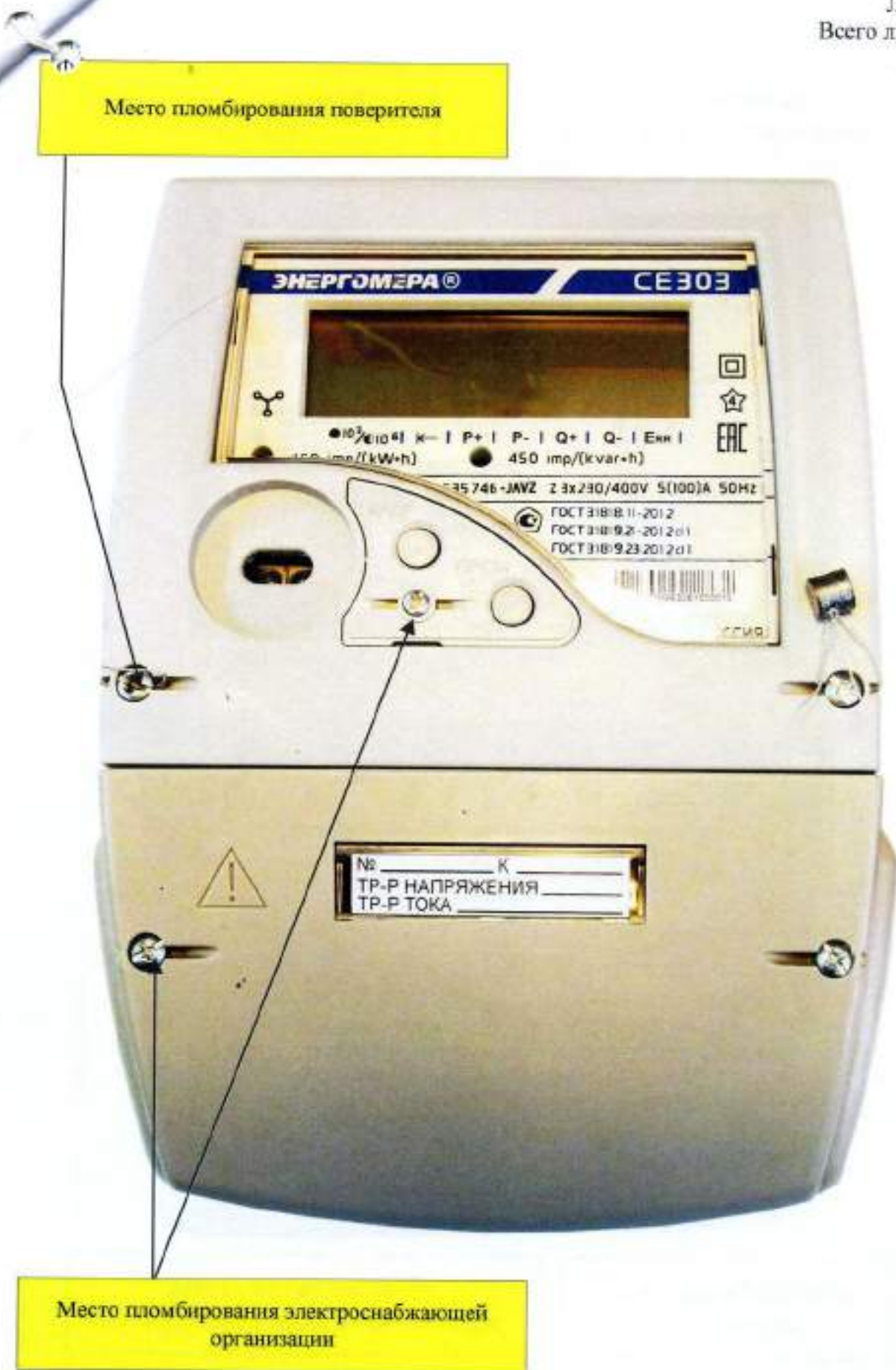
Рисунок 4 - Общий вид счетчика CE 303 S35
