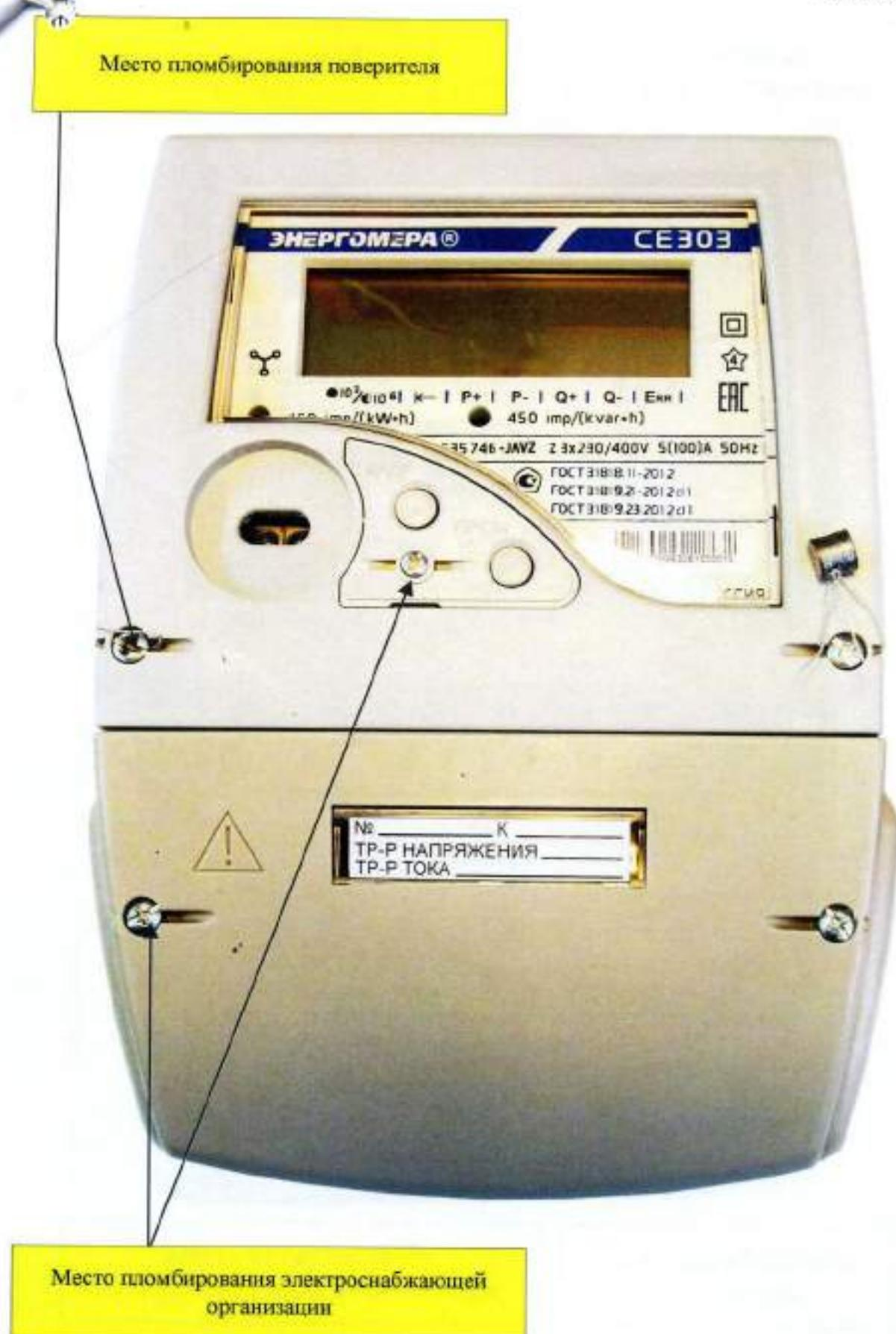
Рисунок 4 - Общий вид счетчика СЕ 303 S35
