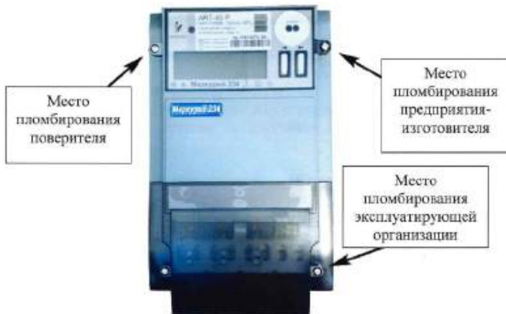
Рисунок 3 – Общий вид счетчиков модификаций «Меркурий 234» и «Mercury 234» с указанием мест пломбирования и нанесения знака поверки
