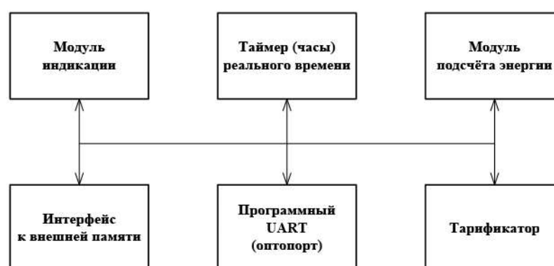
Рисунок 4 - Структура программного обеспечения «Меркурий 236»
