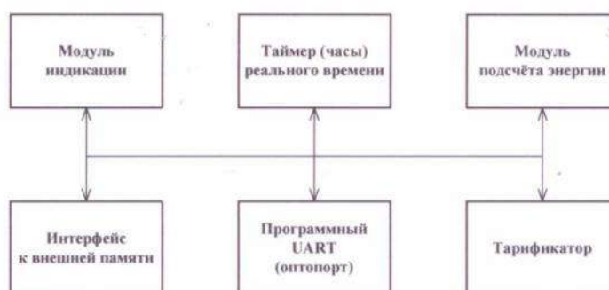
Рисунок 3 - Структура программного обеспечения «Меркурий 230»
