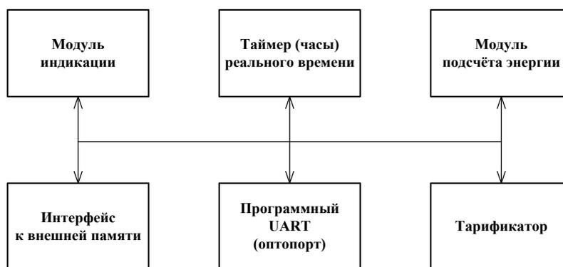
Рисунок 4 - Структура программного обеспечения «Меркурий 236»
