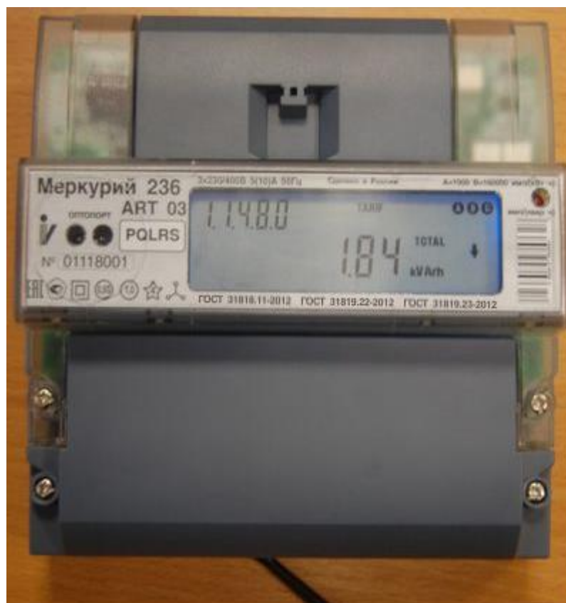
Рисунок 2 – Внешний вид счётчиков «Меркурий 236A(R)(T)...»
