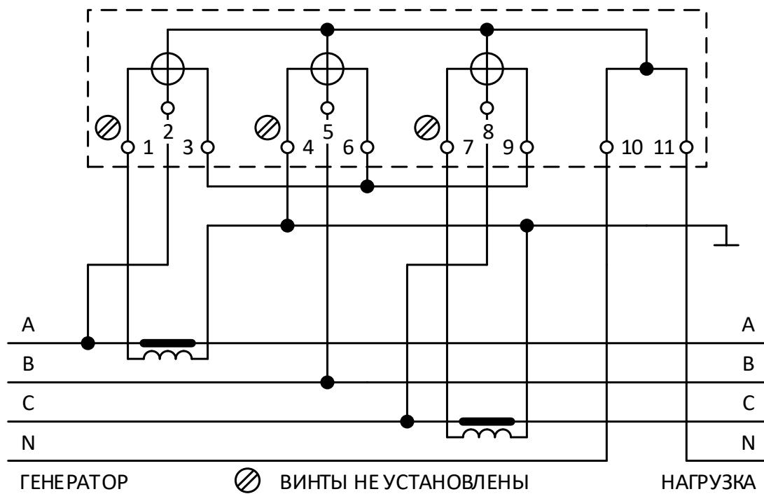
Рисунок Б.5 – Схема подключения счетчиков «Меркурий 234»,
