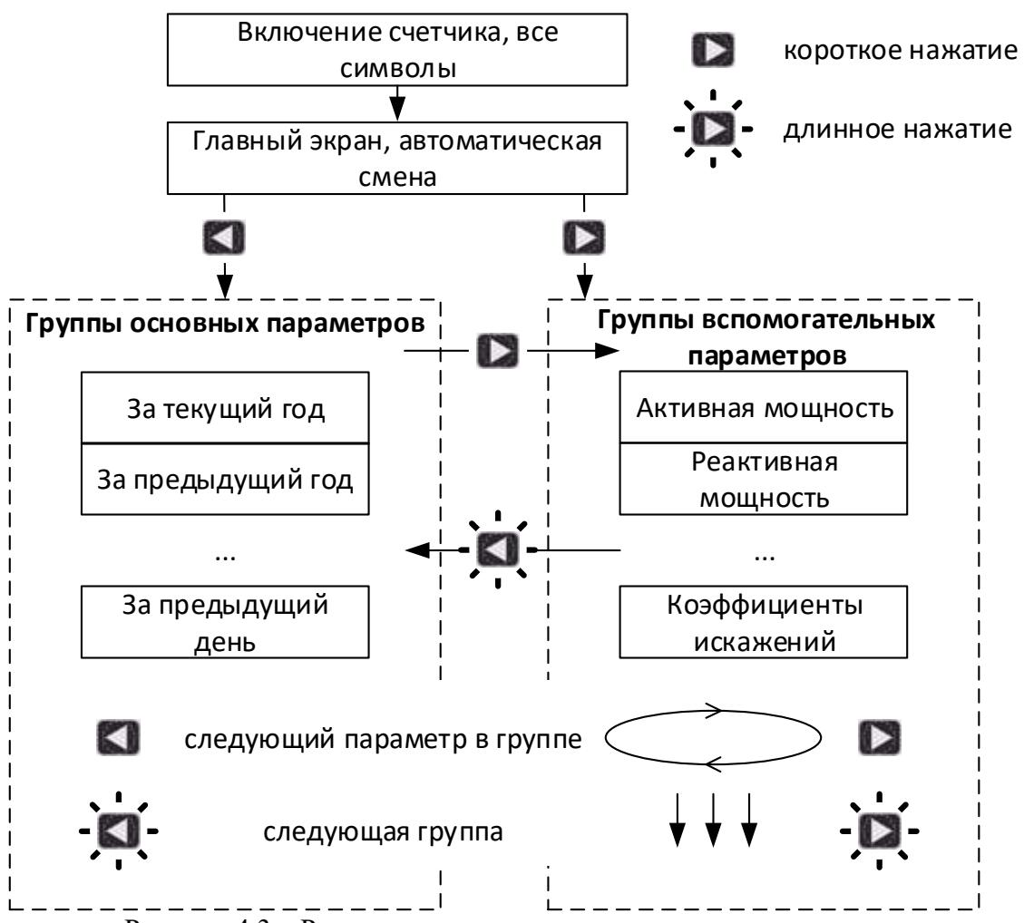
Рисунок 4.3 – Режимы индикации и переходы между ними
