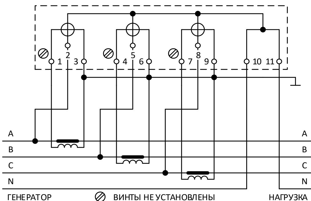
Рисунок Б.4 – Схема подключения счетчиков «Меркурий 234»,
