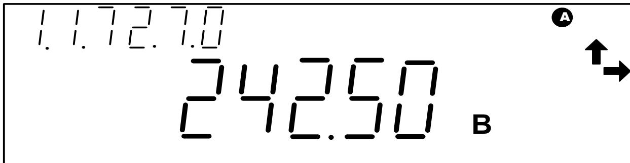
Рисунок 4.6 – Отображение значения напряжения по фазе А
