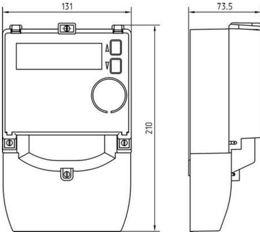
Рисунок А.1 – Габаритный чертеж счетчика «Меркурий 204»
