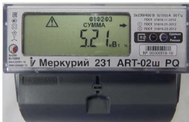
Рисунок 5 - Общий вида счетчика электрической энергии статического трехфазного «Меркурий 231А(Р)Т-0Хш»
