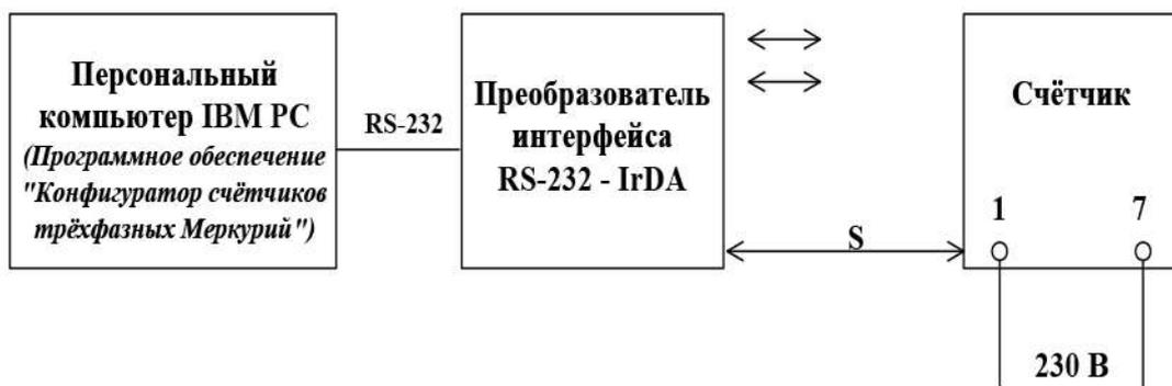
**S** - расстояние от счётчика до преобразователя (0,5...3,0) м
