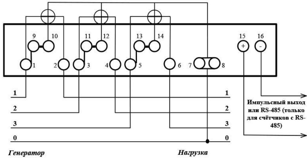
**Рисунок Б.1** – Схема непосредственного подключения счётчика
