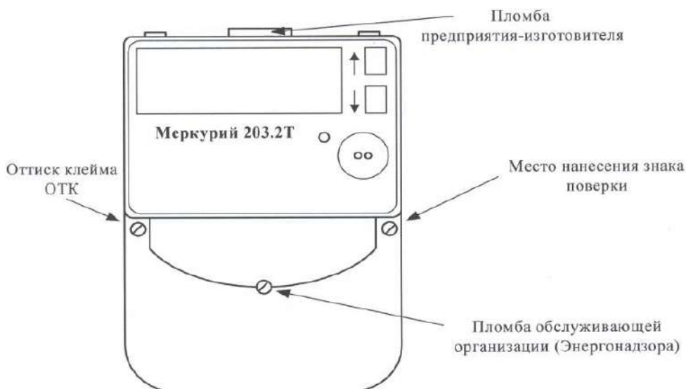
Рисунок 2 - Схема пломбировки счетчиков от несанкционированного доступа, обозначение места нанесения знака поверки
