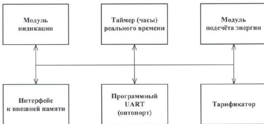
Рисунок 3 - Структура программного обеспечения «Меркурий 203.2Т»
